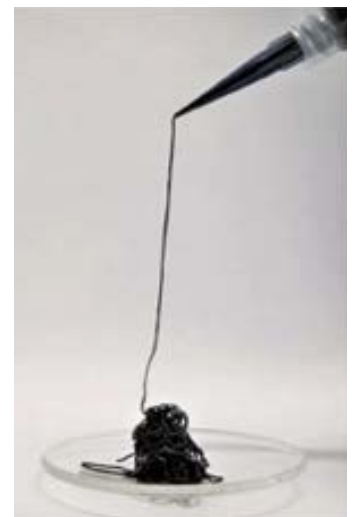
Flüssige bis pastöse Fluide für den Druck von Transistoren in drei Konsistenzen für Flexodruck, Siebdruck und Extrusionsdruck (v.l.). (Quelle: Advanced Materials / Empa)
