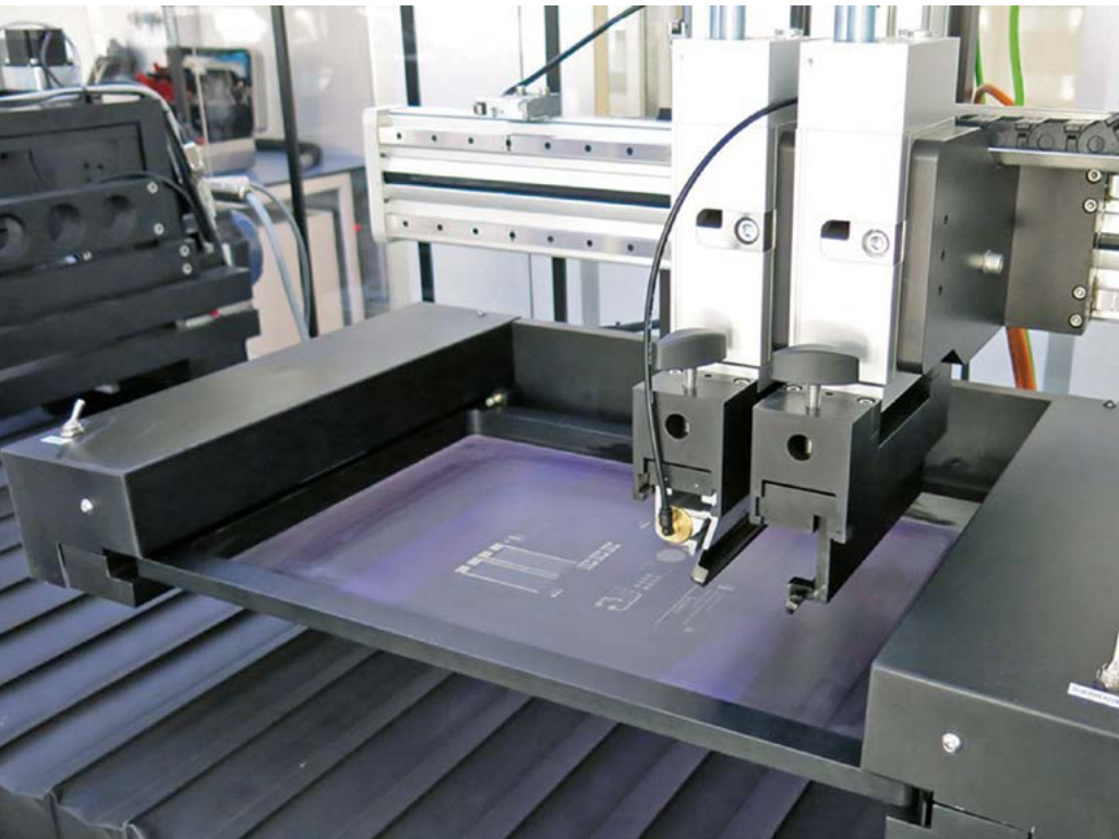
Siebdruck ist das mit Abstand am meisten eingesetzte Druckverfahren gedruckter Elektronik. (Quelle: nsm Norbert Schläfli AG)
