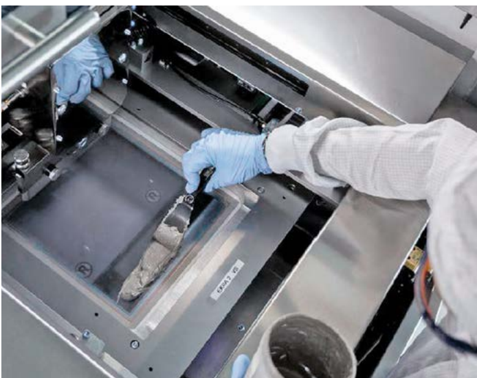
Metallisierung von Silizium-Solarzellen im Flachbett-Siebdruck (links) gegenüber dem Auftrag im Flexodruck (rechts). (Quelle: Fraunhofer Institut für Solare Energiesysteme (ISE))
