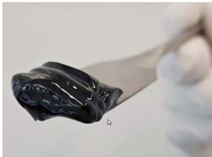
Flüssige bis pastöse Fluide für den Druck von Transistoren in drei Konsistenzen für Flexodruck, Siebdruck und Extrusionsdruck (v.l.). (Quelle: Advanced Materials / Empa)
