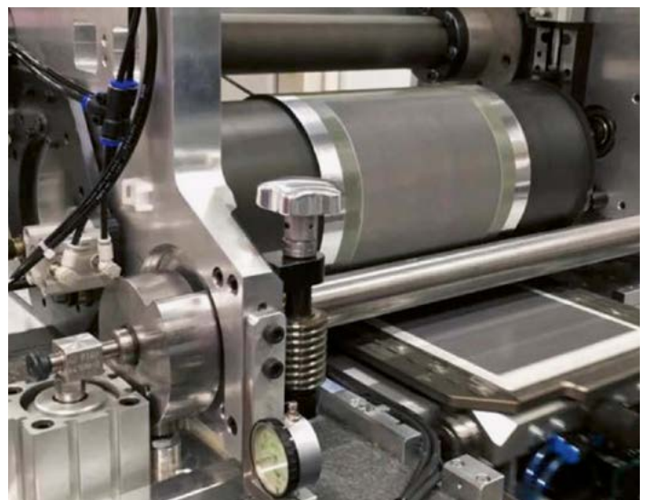
Metallisierung von Silizium-Solarzellen im Flachbett-Siebdruck (links) gegenüber dem Auftrag im Flexodruck (rechts). (Quelle: Fraunhofer Institut für Solare Energiesysteme (ISE))
