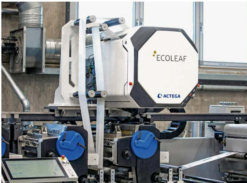
Die EcoLeaf Technologie zur Metallisierung wird entweder werksseitig in analoge oder digitale Druckmaschinen oder Weiterverarbeitungssysteme integriert oder in vorhandenen Drucksystemen nachgerüstet. (Quelle: Actega)
