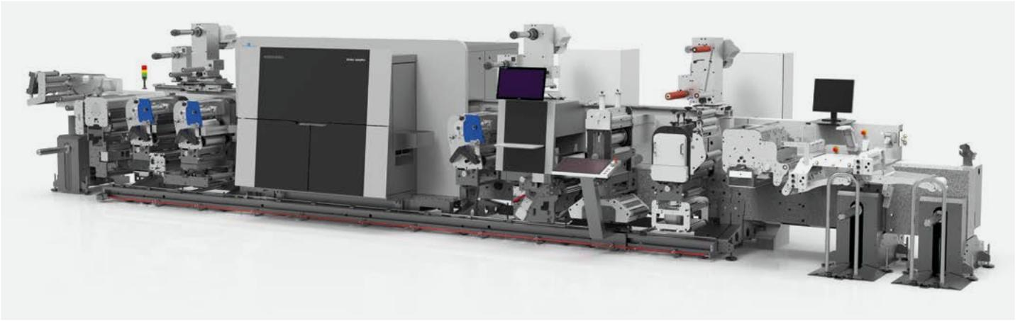
Die hybride Druckveredelung der Gallus Labelfire 340 mit Digital Embellishment Unit (DEU) umfasst digitalen Lack sowie auch Folienprägung mit anschliessenden Metalliceffekten im Digitaldruck. (Quelle: Gallus Ferd. Ruesch AG)
